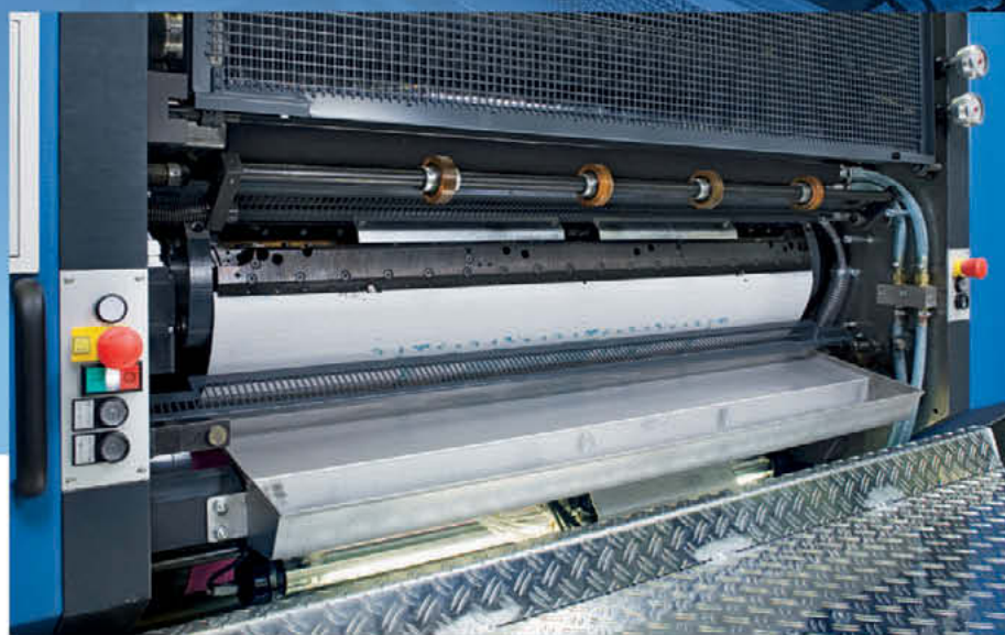
Sistema automático de cambio de planchas de impresión MechaTronic
